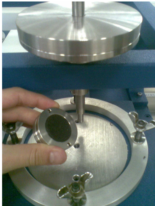
Figura 12.: Equipamento utilizado para os testes de desgaste.
