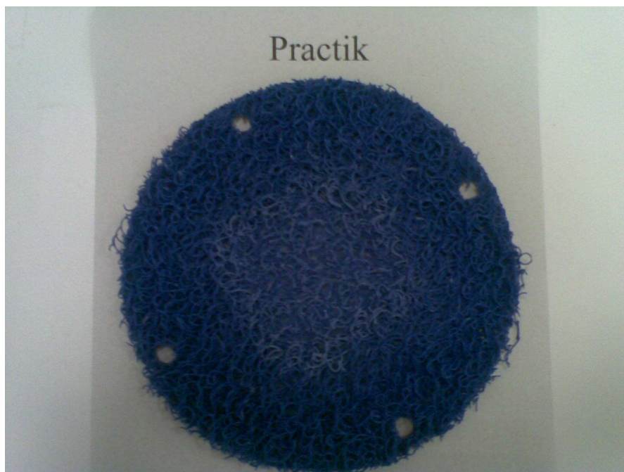
Figura 2.: Practik liso após 3000 ciclos.
